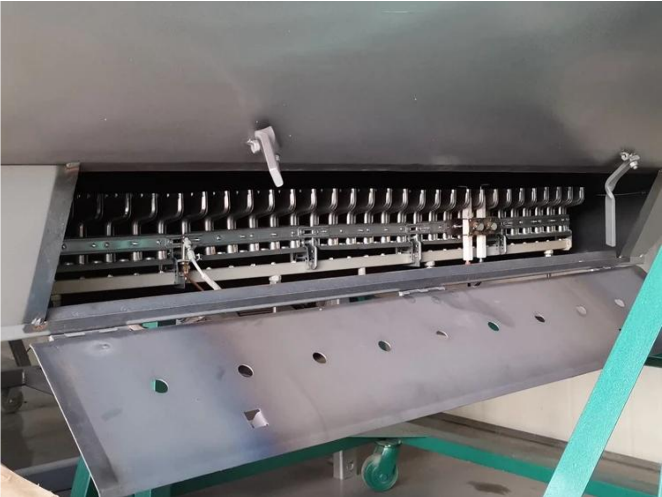
Pelotón de fuego de combustión en forma de T que cubre el barril de fijación del té, área de combustión hasta el 100%.
