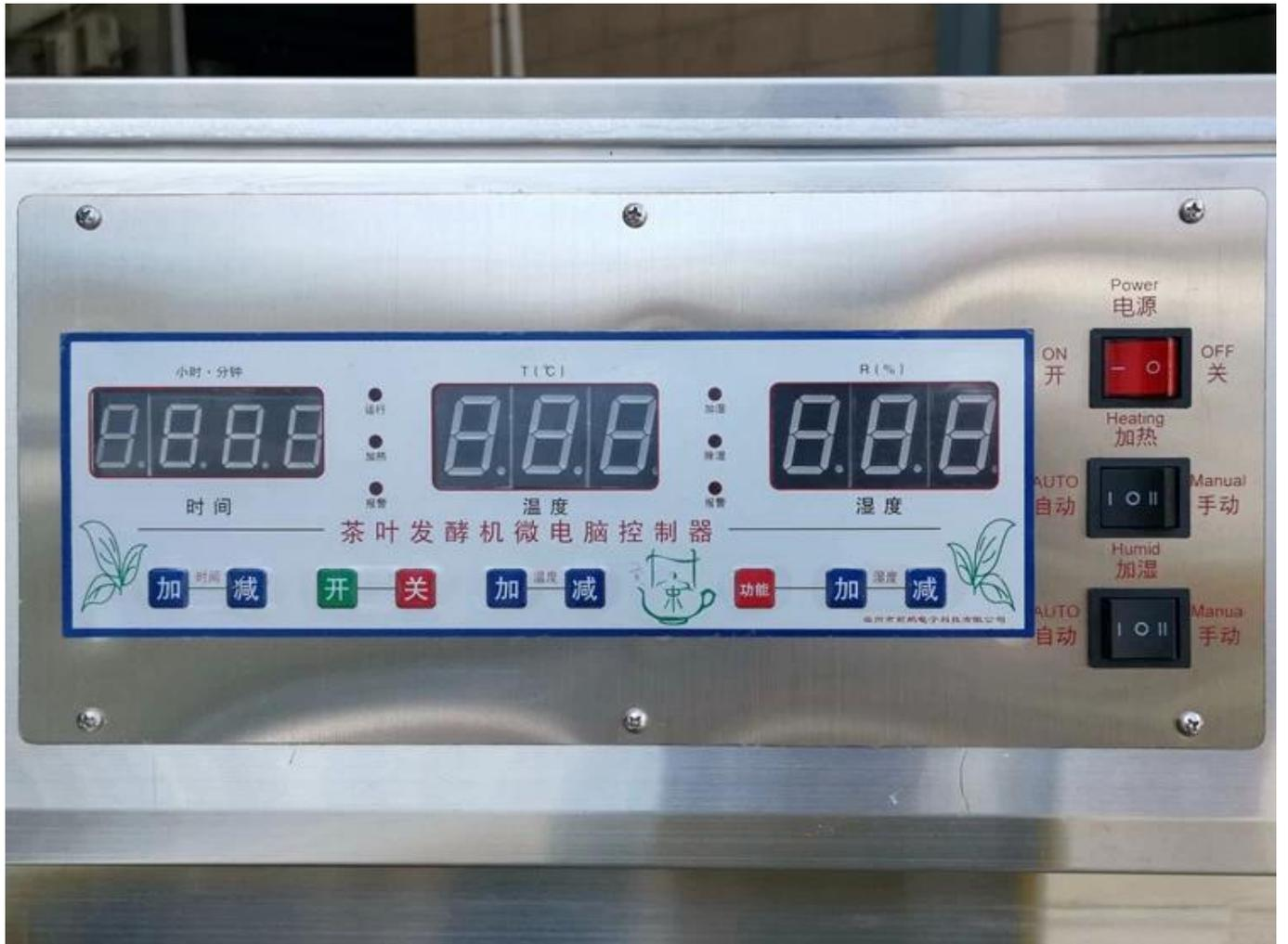
El sistema de control integrado por microordenador, la temperatura y la humedad se pueden controlar de forma inteligente.
