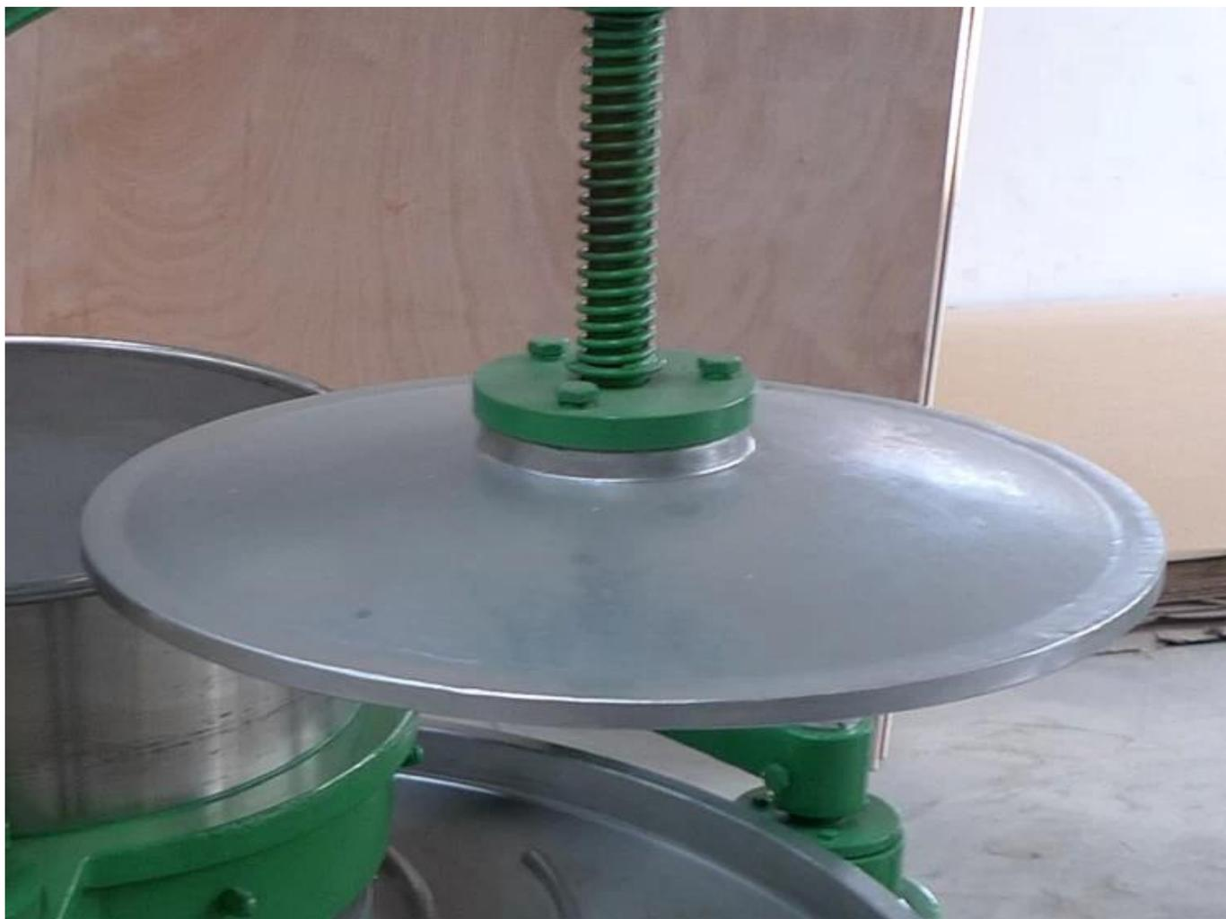
El diseño único de la cubierta de la máquina laminadora pequeña y mediana se puede girar para mejorar la tasa de té en tiras.
