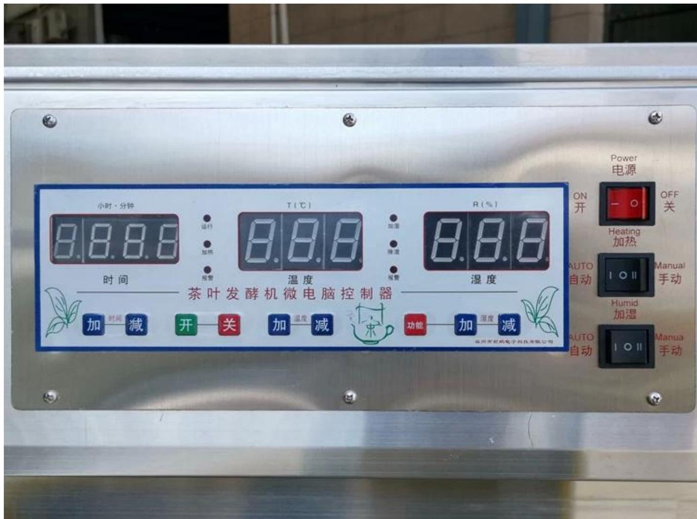
El sistema de control de microordenador integrado, la temperatura y la humedad se pueden controlar de forma inteligente.
