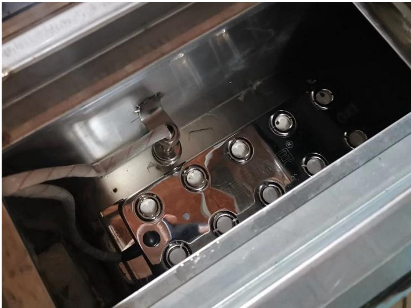
El tanque de agua con atomizador está instalado en la parte superior, y la niebla de agua atomizada llena naturalmente el interior de la máquina de fermentación de té, y la fermentación es más uniforme.
