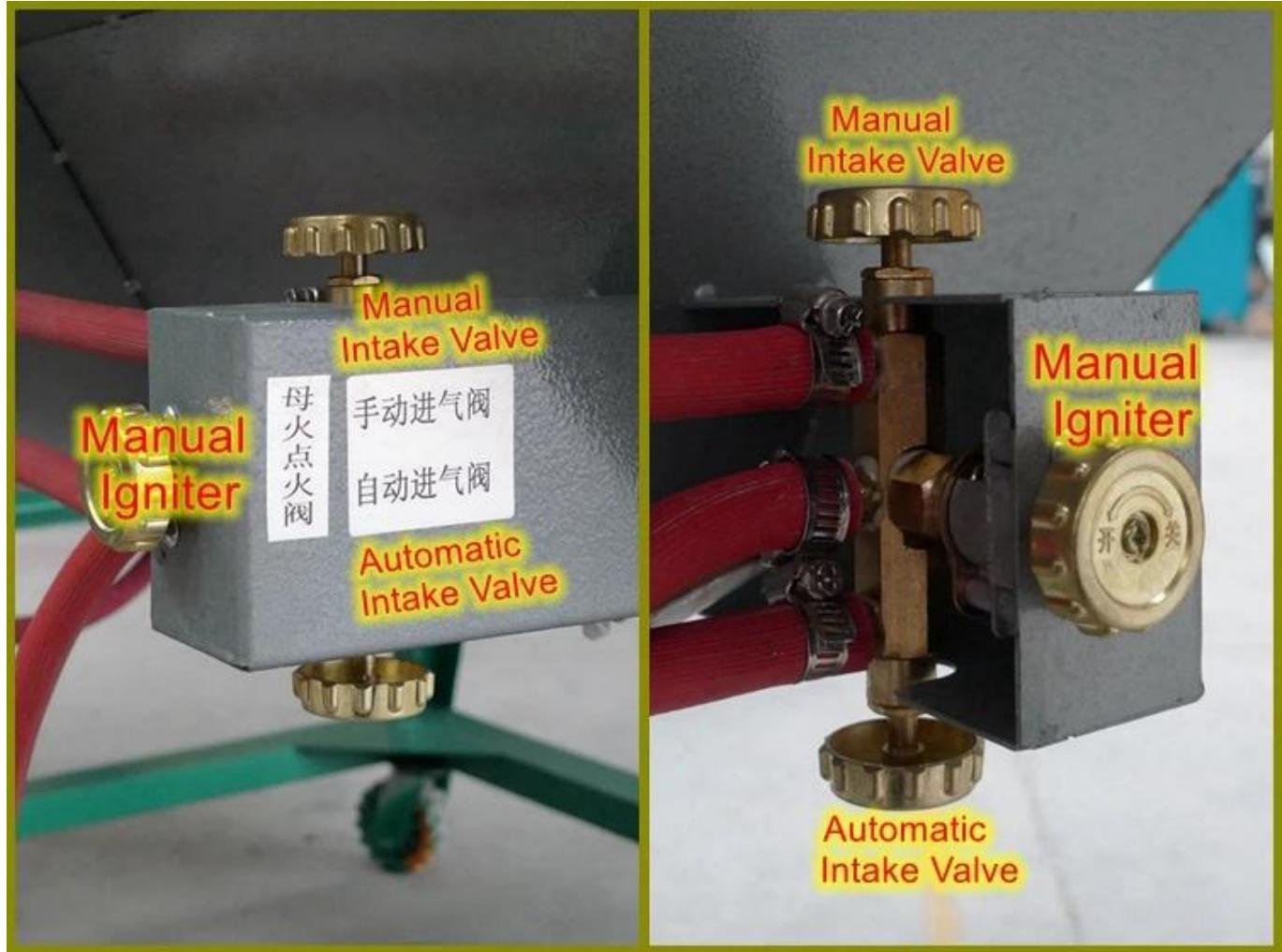
Hay tres válvulas en la parte inferior, que se pueden encender manualmente en caso de un corte de energía, para que no se desperdicien hojas de té.
