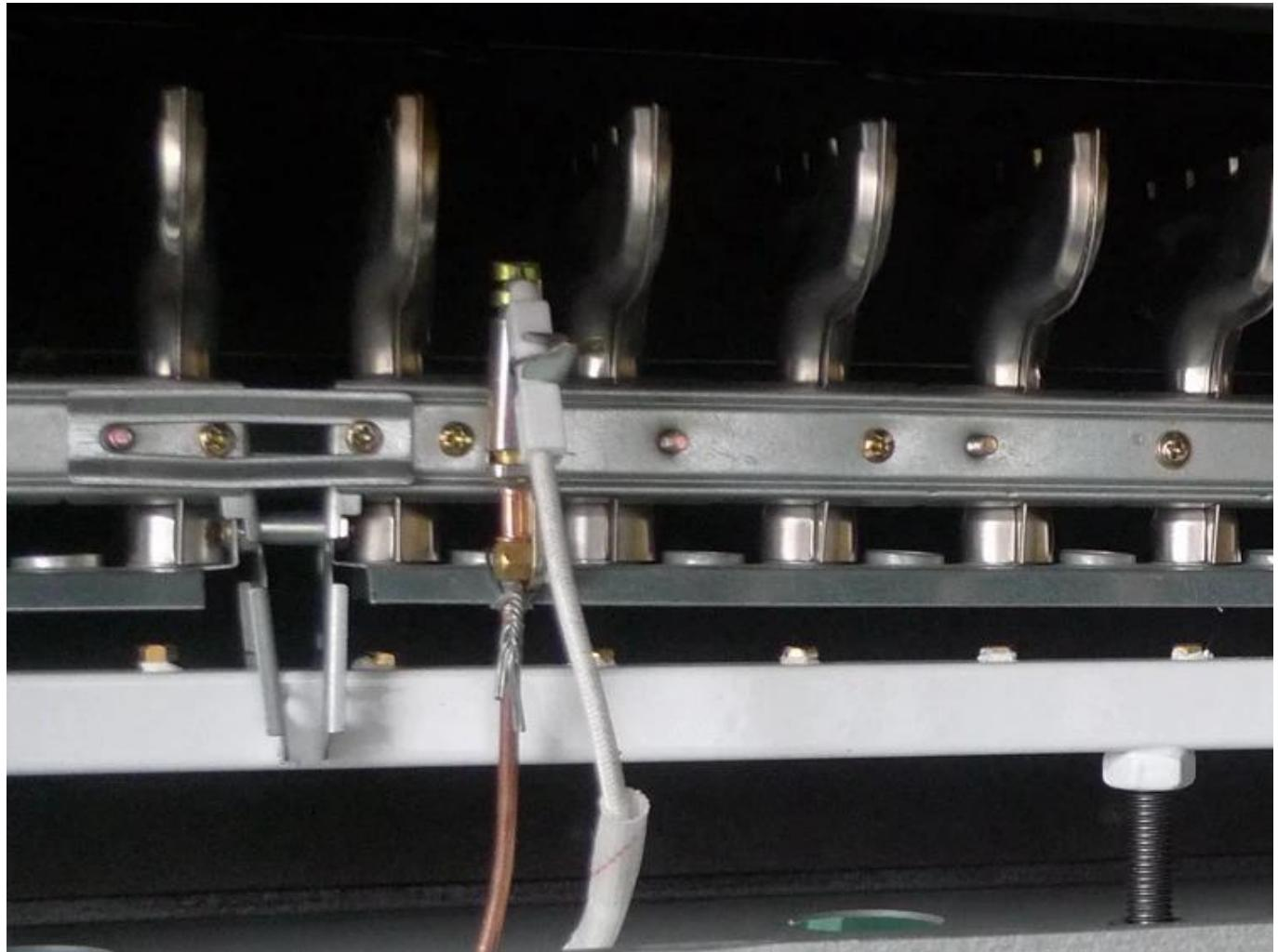
Preservar el diseño del cabezal de combustión de la llama constante, reservar la llama constante después de que el encendido sea exitoso, volver a encender desde la llama constante, reducir la presión de la aguja de encendido y la bobina de encendido y mejorar la vida útil.
