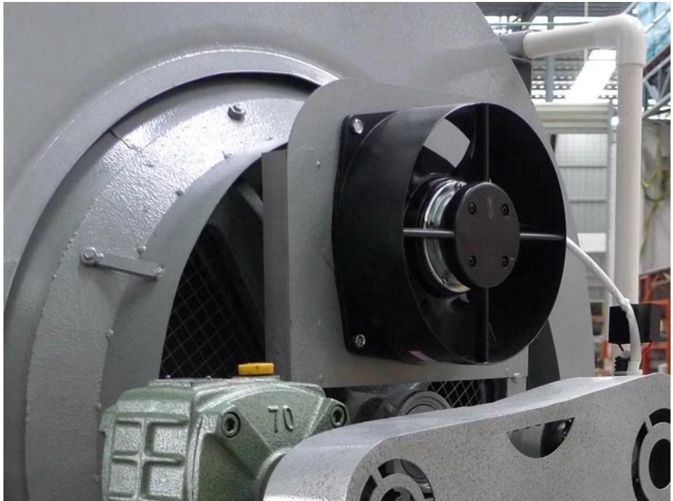
Se agrega un extractor de aire en la parte trasera, que se puede encender y apagar manualmente, lo que puede expulsar rápidamente el aire caliente y húmedo dentro de la máquina para evitar que el té se congestione y afecte el sabor.
