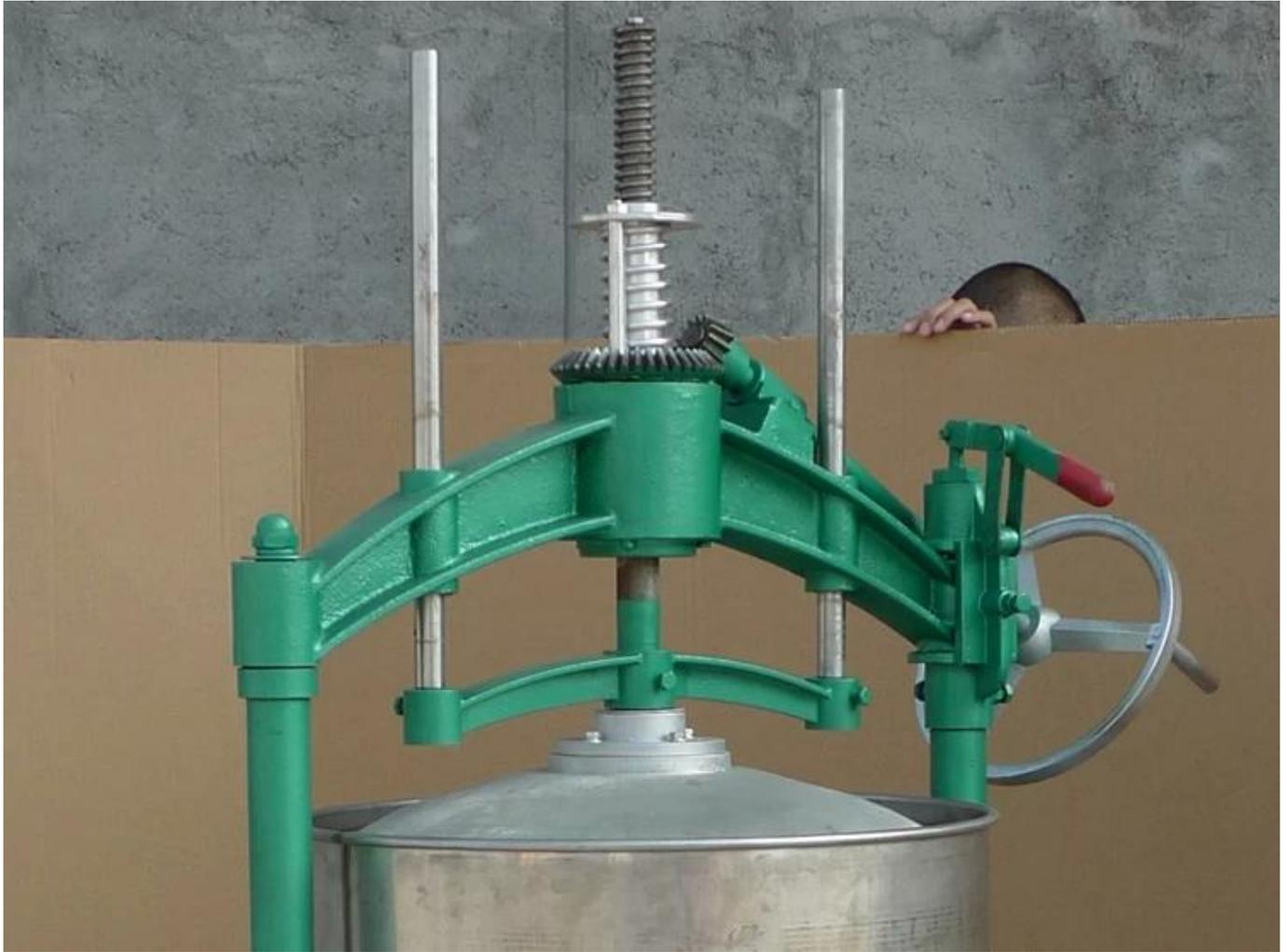
Los brazos dobles adoptan una estructura de cubierta abierta de doble brazo, que tiene una gran capacidad de carga y un funcionamiento estable.
