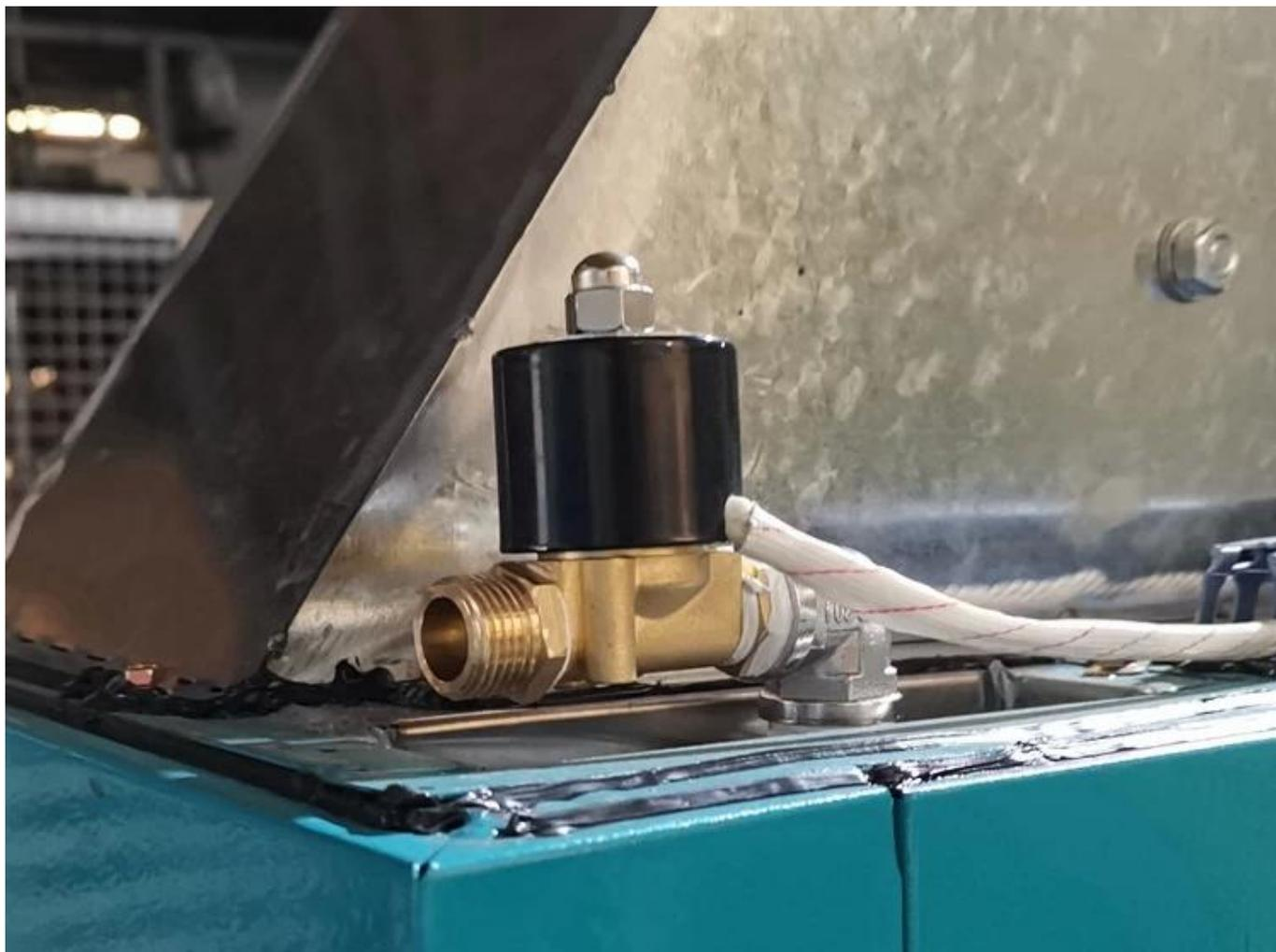
El diseño de la válvula solenoide asegura que el agua en el tanque se mantenga a la mejor altura de atomización.
