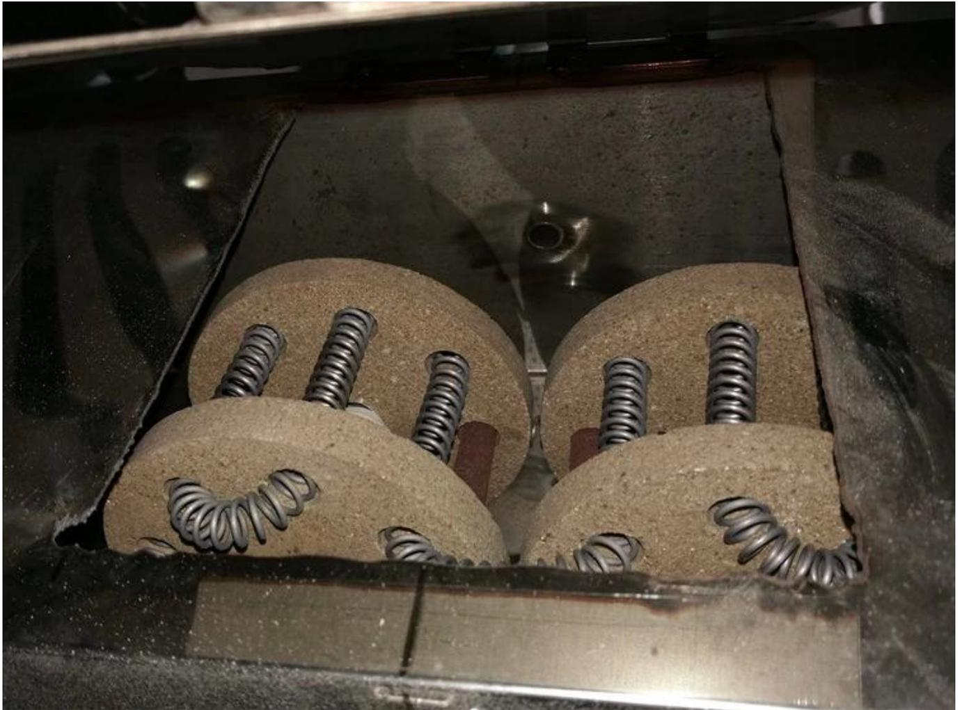
Utilizando un cable calefactor eléctrico duradero con un diámetro de 1 mm y una torta aislante de polímero resistente a altas temperaturas, la vida útil del cable calefactor aumenta en un 40% en comparación con otras empresas.
