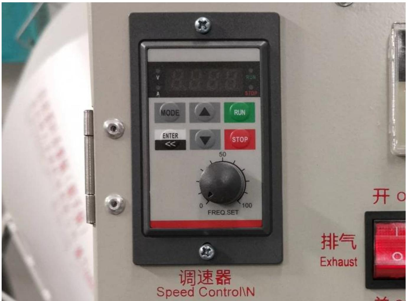
La velocidad de la máquina de fijación de té se puede ajustar, de acuerdo con el té de diferentes áreas de producción, se pueden ajustar diferentes velocidades
