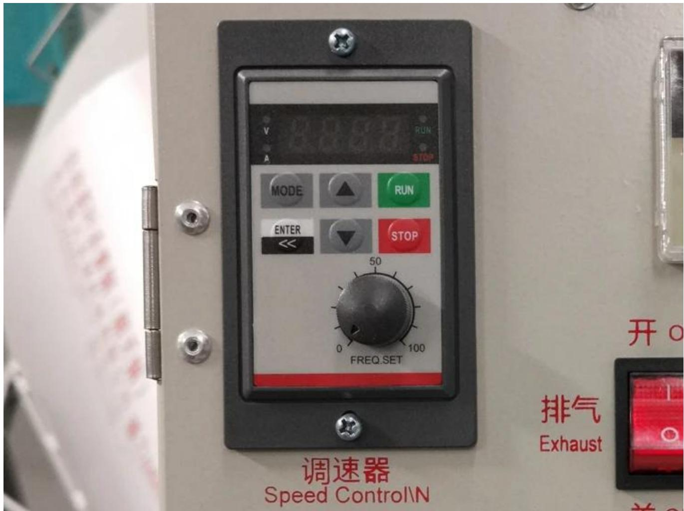
La velocidad de la máquina de fijación de té se puede ajustar, según el té de diferentes áreas productoras, se pueden ajustar diferentes velocidades.
