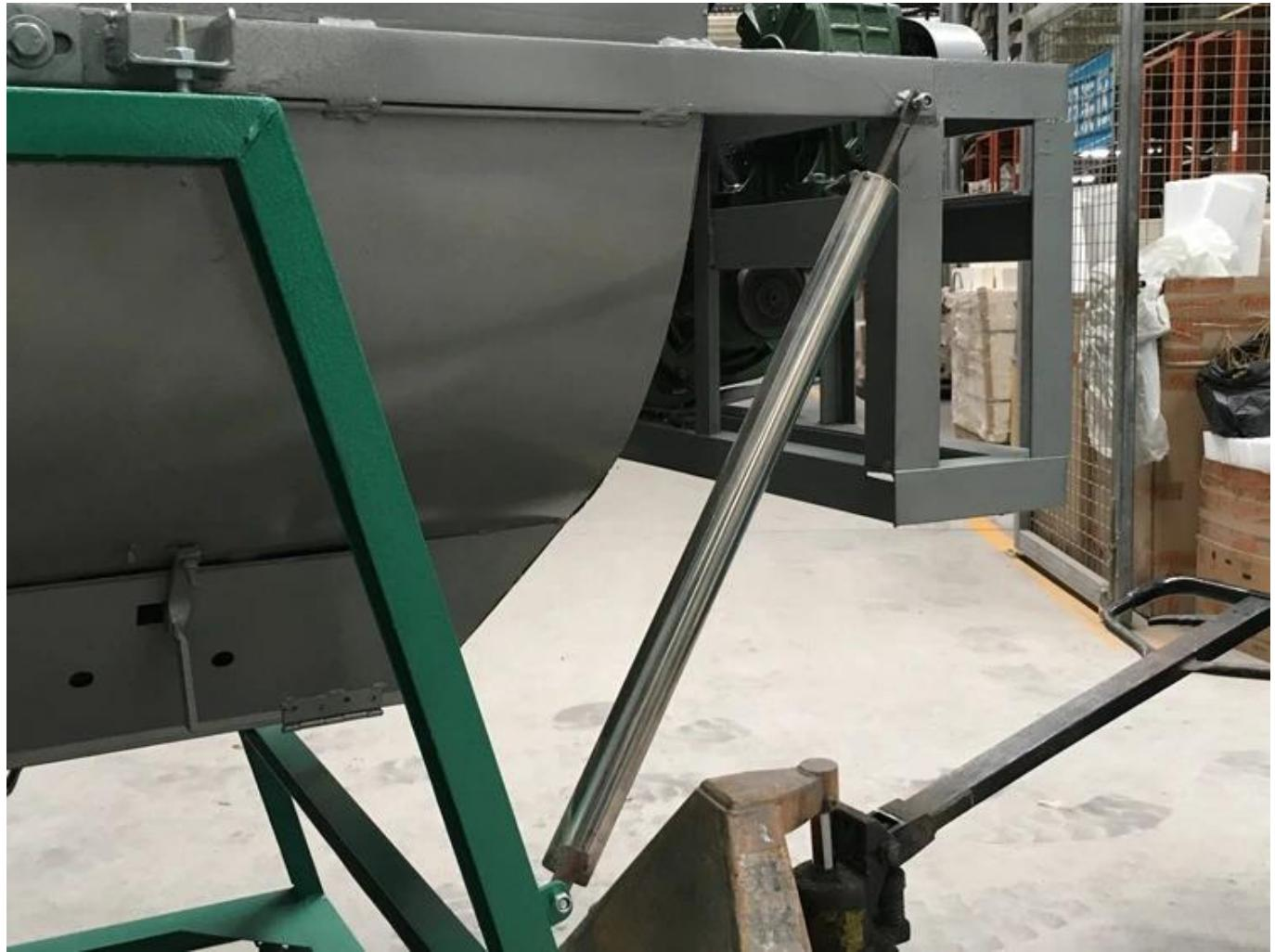
Diseño de amortiguador neumático, la máquina retrocede automáticamente y la velocidad de caída es estable.
