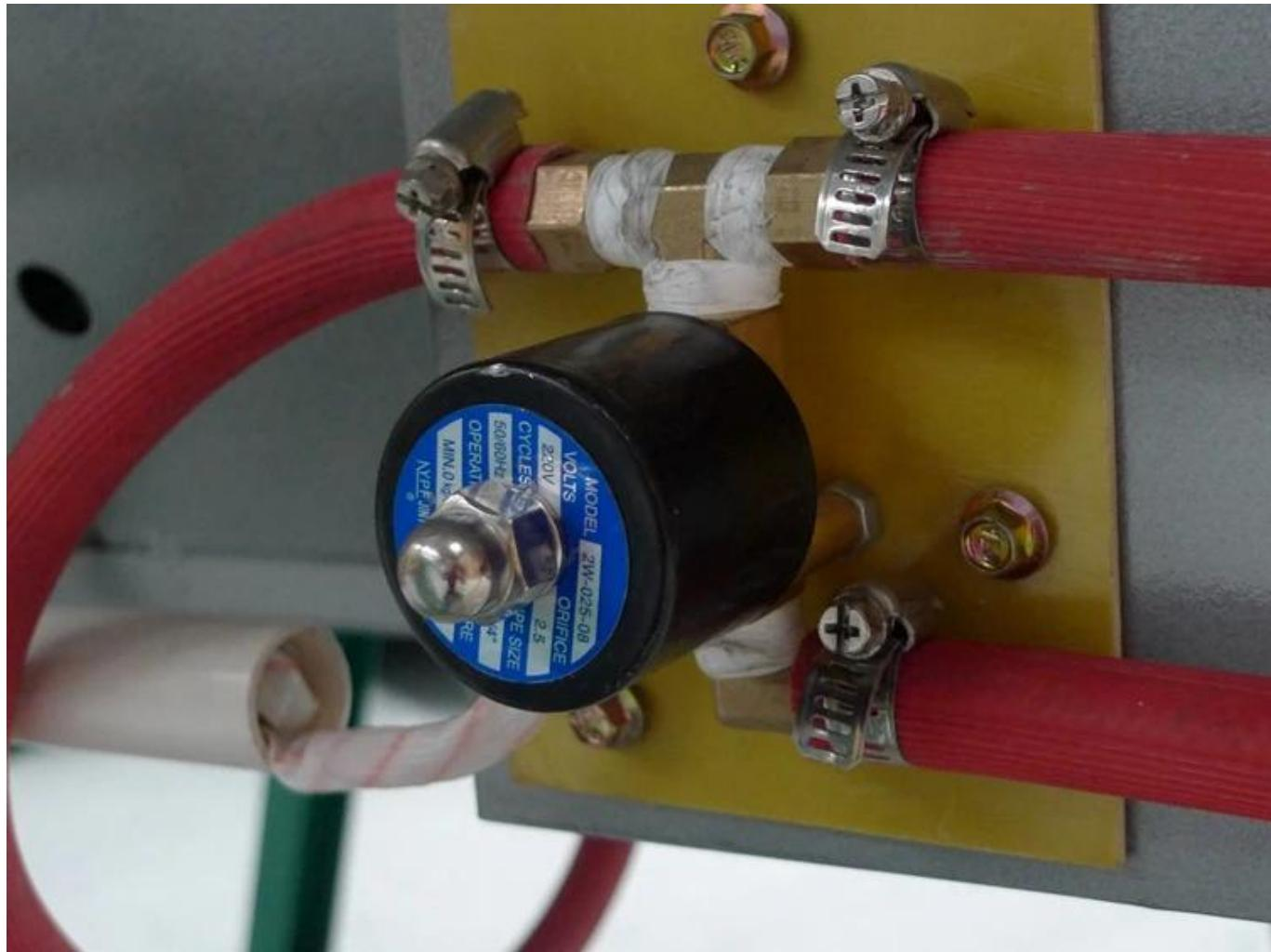
Diseño de válvula solenoide automática, el calentamiento se inicia y se detiene automáticamente, la válvula solenoide se cierra automáticamente cuando la temperatura alcanza la temperatura establecida y la máquina deja de calentar. Cuando la temperatura es inferior a la temperatura establecida, la válvula solenoide se abre y la máquina se recalienta, lo que puede ahorrar combustible.
