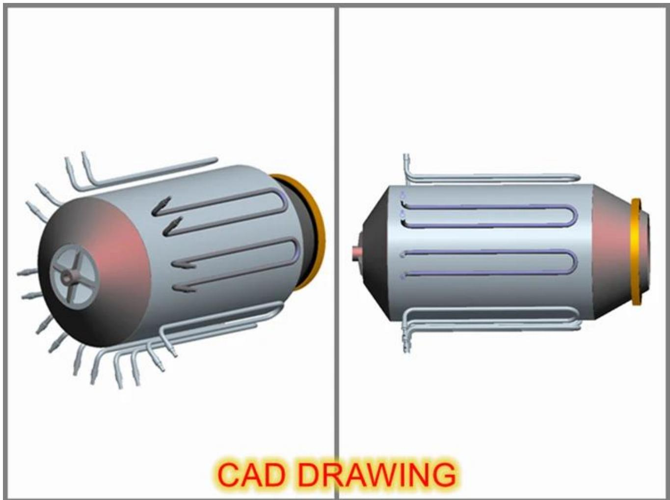
Un denso tubo de calefacción eléctrica rodea todo el tambor de fijación para garantizar el calor uniforme del tablero del cilindro y la fijación del té de manera más uniforme.
