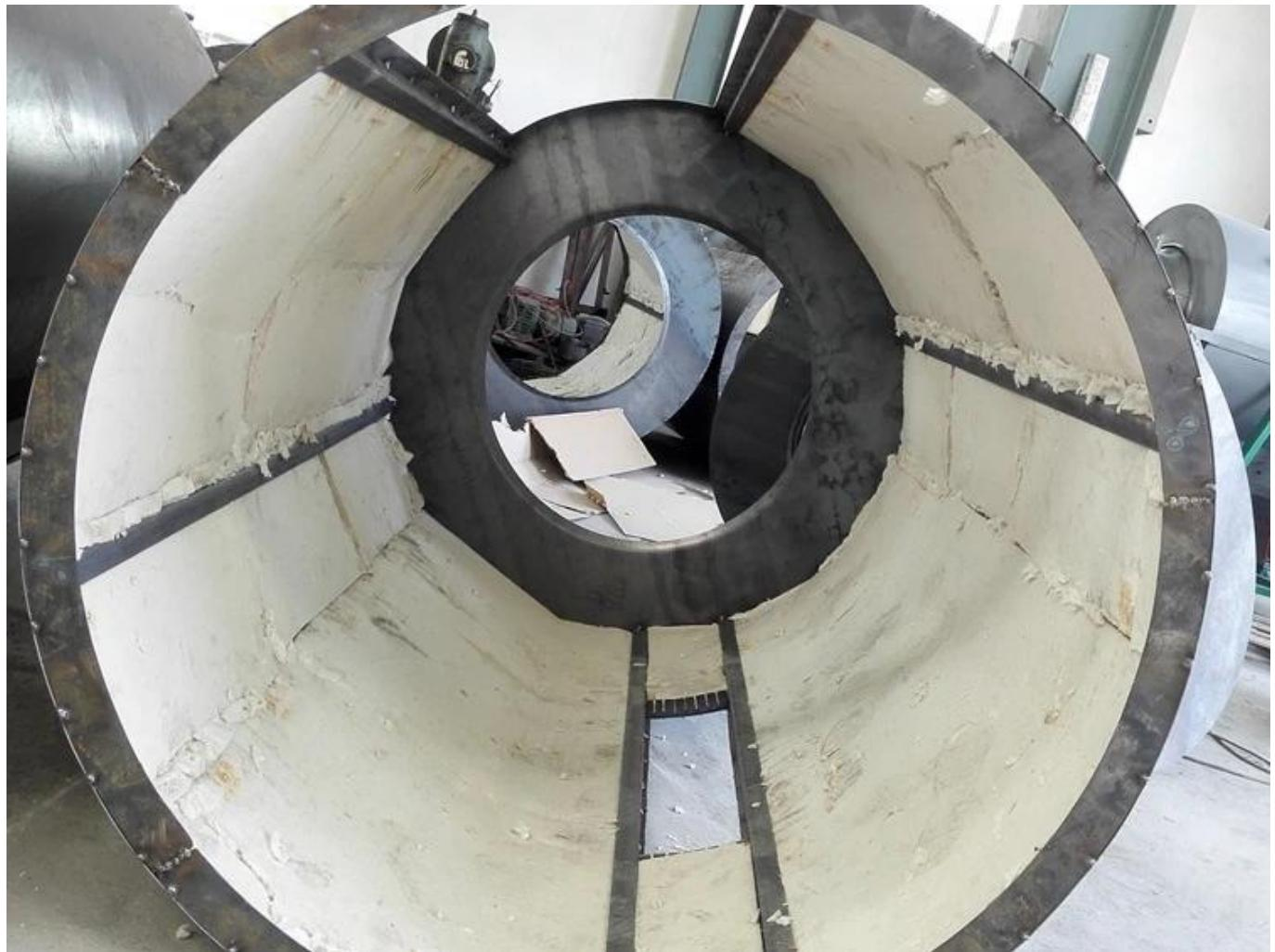
El cañón interior utiliza un nuevo tipo de material aislante ignífugo respetuoso con el medio ambiente, con un espesor de hasta 20 mm, reduce en gran medida la pérdida de calor y ahorra energía en un 30%.
