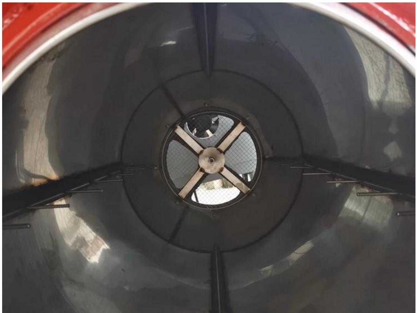
Al usar una placa de acero ultragruesa de 2,5 mm, el cambio de temperatura es pequeño y se conserva bien el calor, la hoja de té no se dañará (otras fábricas solo usan placa de acero de 1,6 mm)
