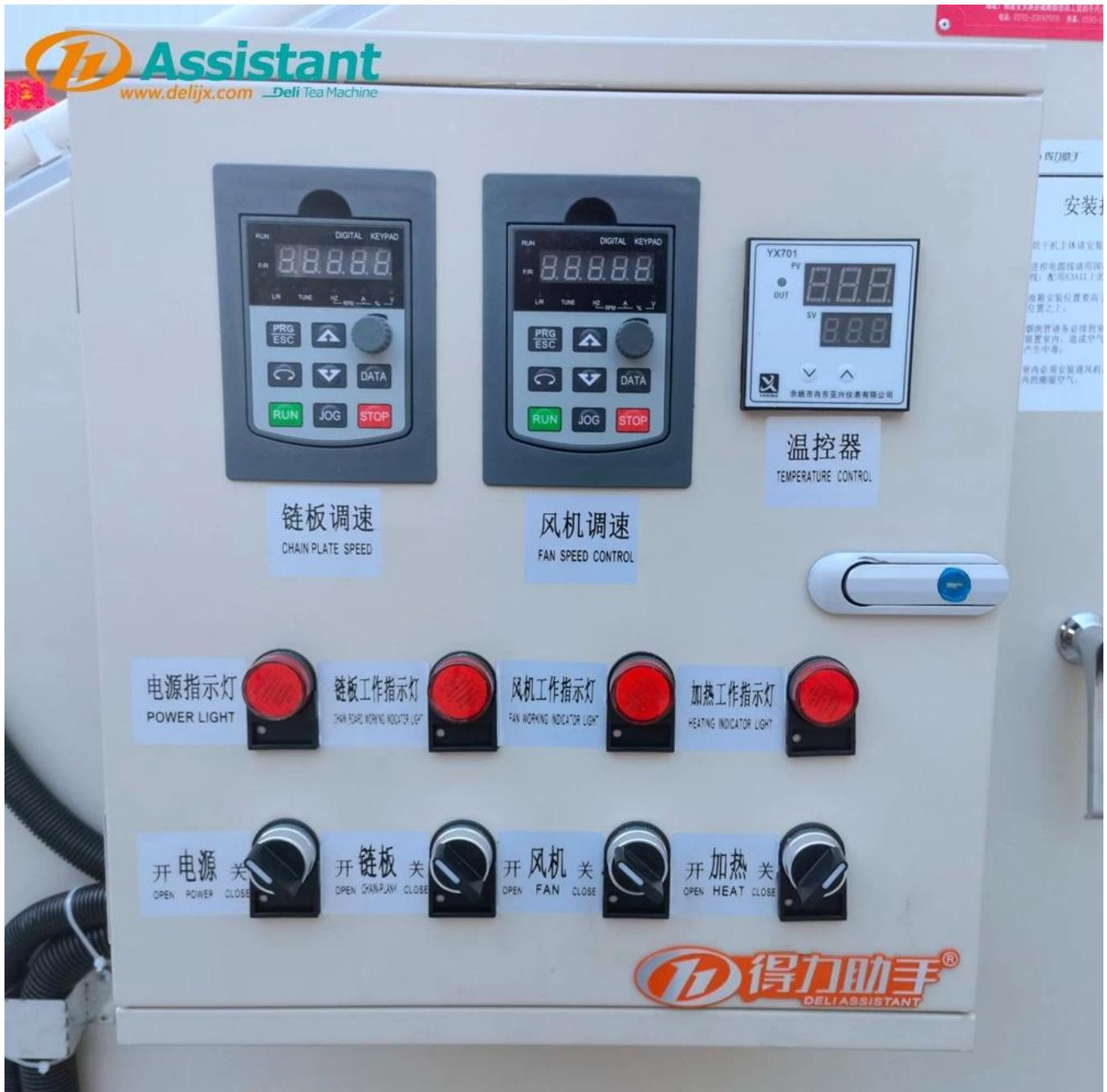
**Caja de control totalmente integrada, fácil y rápida de usar.**
