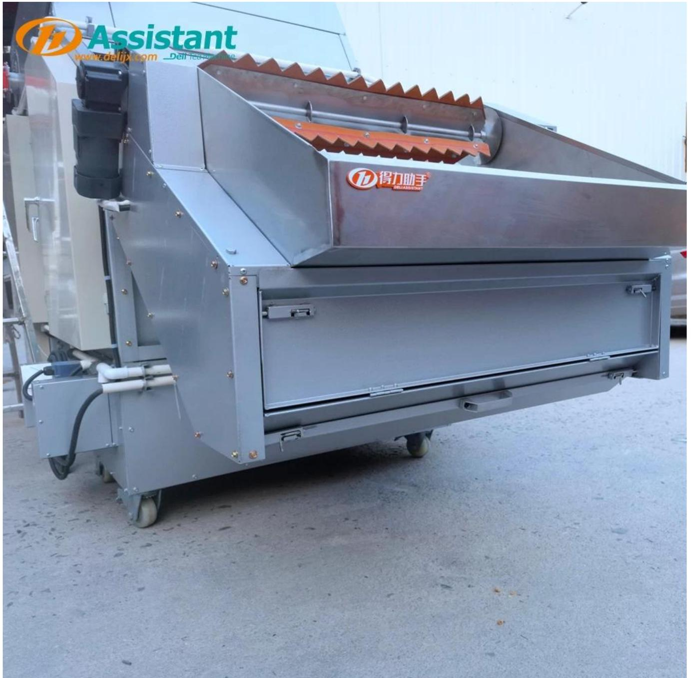
**Se agrega la bandeja colectora de polvo frontal y el té en polvo se puede limpiar tirando directamente de la bandeja, que es limpia e higiénica.**
