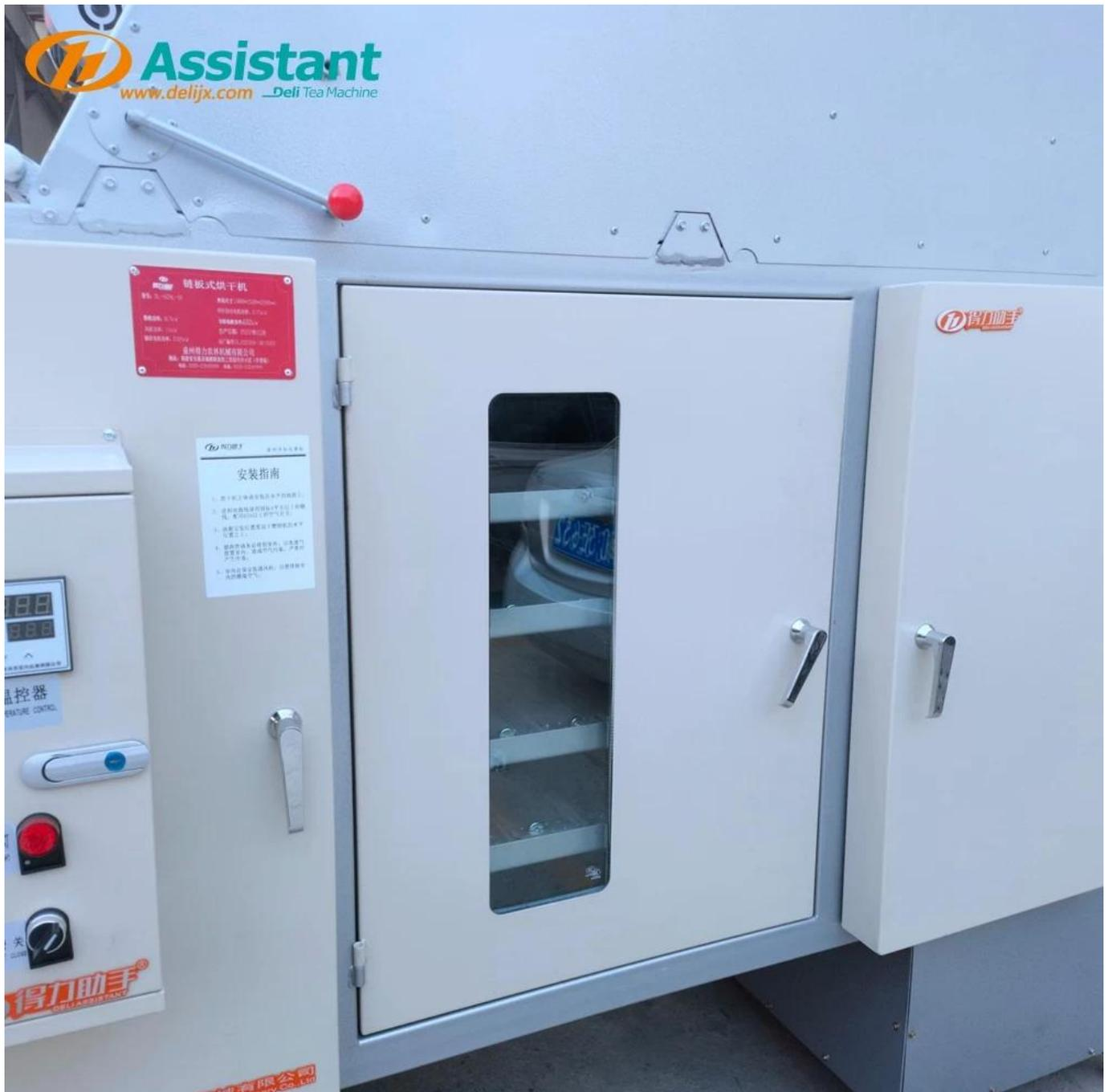
**Con una ventana de observación transparente, puede observar el estado del té interno en cualquier momento.**
