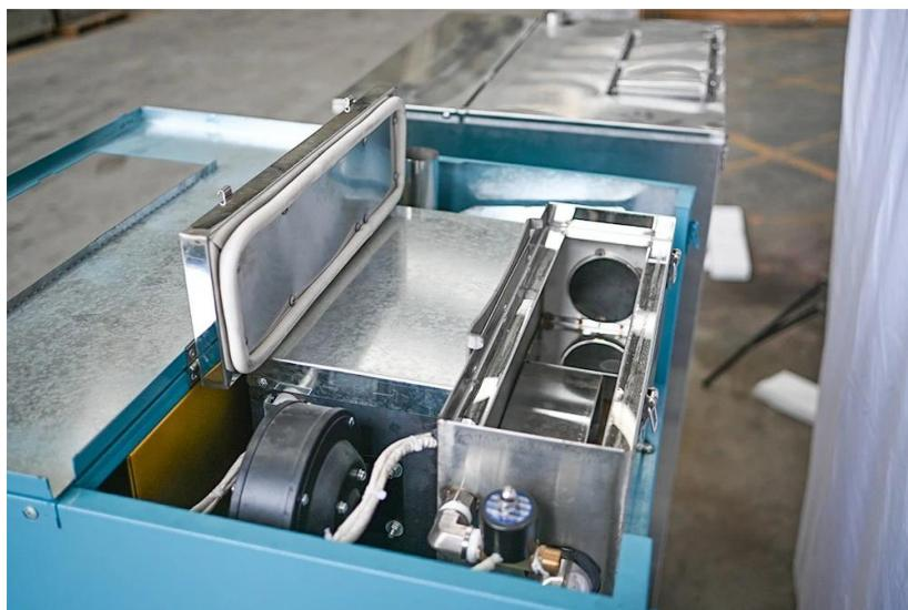
El tanque de agua con atomizador está instalado en la parte superior y la niebla de agua atomizada llena naturalmente el interior de la máquina de fermentación de té y la fermentación es más uniforme.
