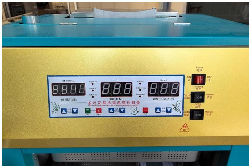
El sistema de control por microordenador integrado, la temperatura y la humedad se pueden controlar de forma inteligente.
