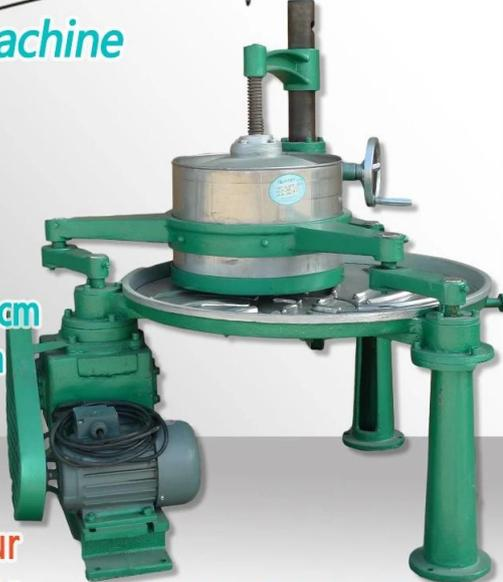
**Máquina de torsión de torsión de té de tipo medio Battel de 40 cm DL-6CRT-40**
