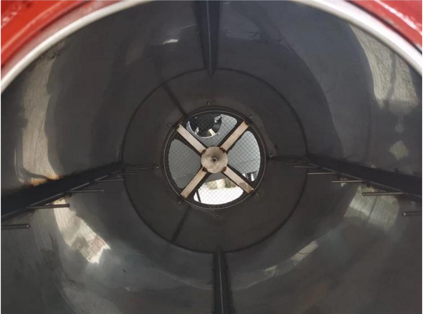
Usando una placa de acero ultragruesa de 2.5 mm, el cambio de temperatura es pequeño y una buena conservación del calor, la hoja de té no se dañará (otras fábricas solo usan una placa de acero de 1.6 mm)
