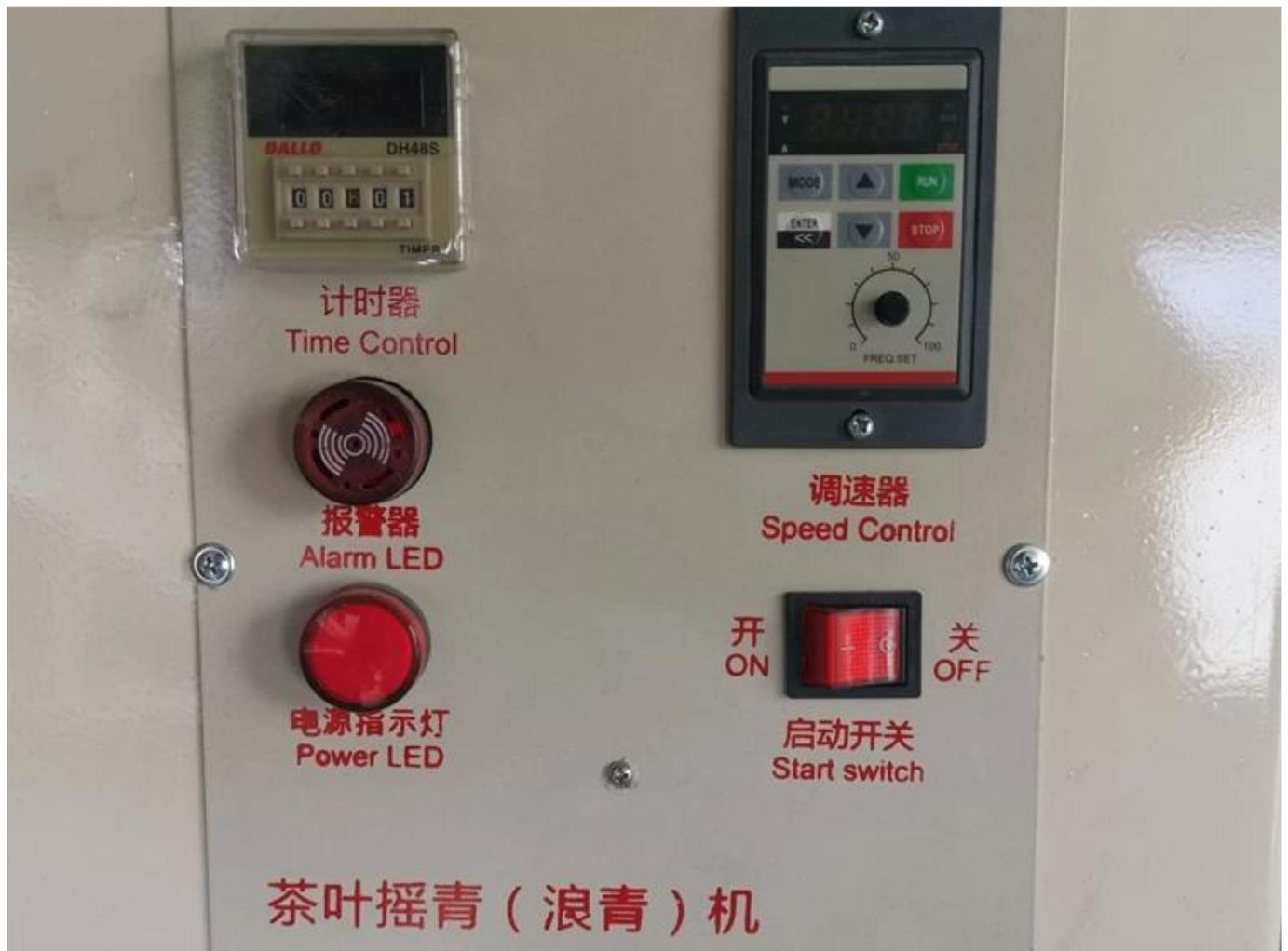
El panel de control integrado en chino e inglés, con función de control de tiempo y velocidad ajustable, es el equipo necesario para la producción de té oolong de alta calidad.
