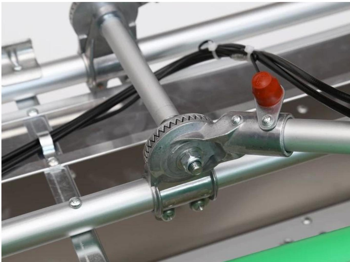
Diseño de cierre tipo engranaje, alta resistencia, no suelto, proceso de recolección de té más relajado
