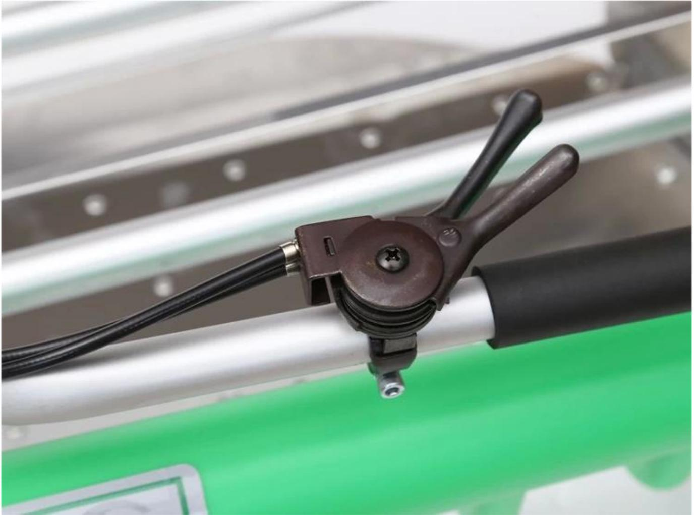
Diseño integrado del interruptor de embrague y acelerador, hecho de aleación de alta resistencia, la vida útil aumenta en un 100%
