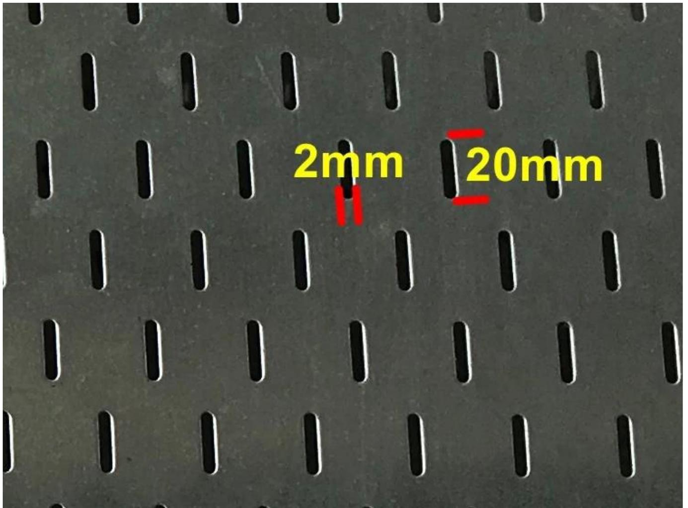
El tamaño de malla óptimo obtenido por muchos experimentos, el té roto y los polvos de té se filtraron durante el proceso de agitación del té oolong.
